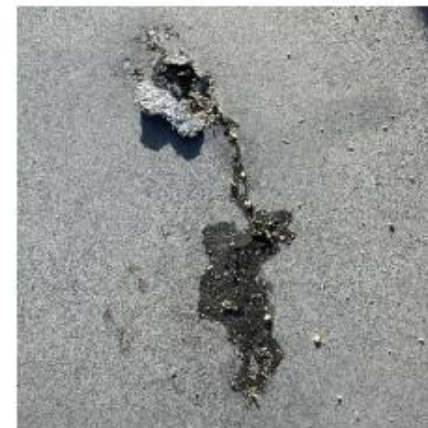
Img. 4 : Corrosion sous-jacente avancée traversant la protection en zinc
